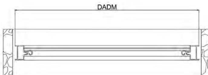
**Pour les SECURALUX sans projection, il faut retirer 5 mm à la largeur entre tableaux.**
