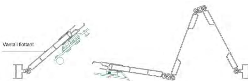
En cas de vantail flottant les arrêts de vents intégrés ne sont pas réalisable
