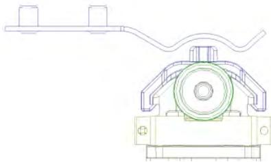
Lame ressort pour bridage avec le chariot de la lame battement (Masqué dans le rail haut)
