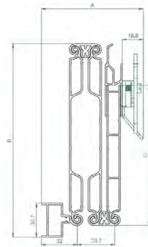
Dans le cas d'un vantail flottant (gauche), la côte C mini est de 54 mm
