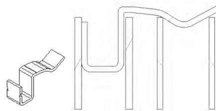
Butée haute pour le maintien de la lame de battement contre le tablier de la persienne en position ouverte (Visible en haut des lames et non laquée)
