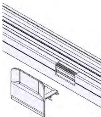
Le guide lame permet de venir combler l'usure présent dans les rails haut et bas.
