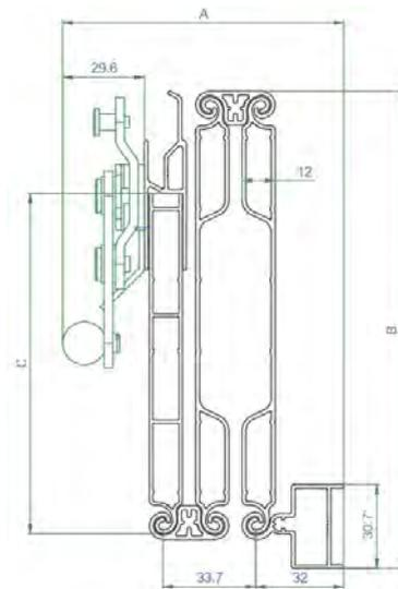
Dans le cas d'un vantail flottant (gauche), la côte C mini est de 52 mm
