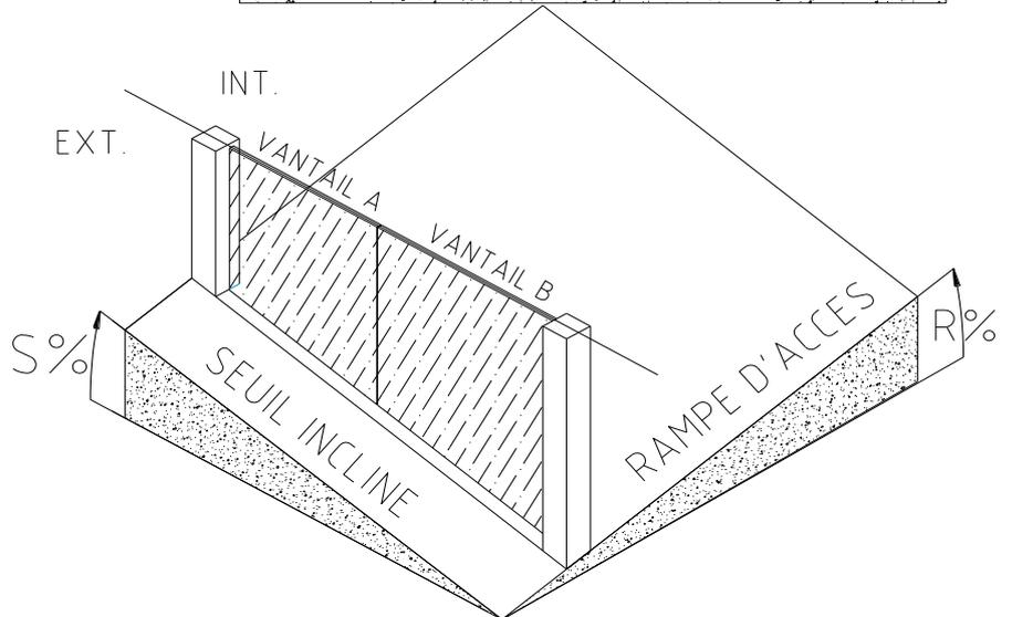
Vantail A : Régulateur si  $S\% \geq R\%$
